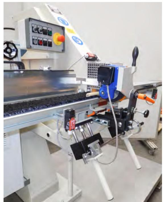
Sicherheitsabdeckung der Führungsschiene mit elektrischer Verriegelung
