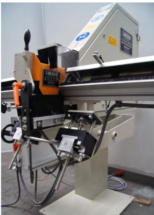
Zentrale Höhenverstellung mit zwei Spindeln und seitlicher Abstützung für schwere Teile
