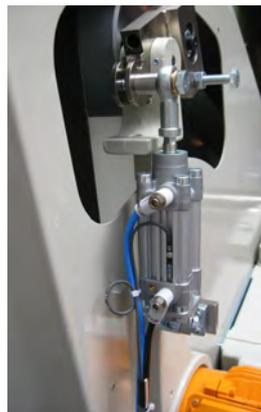
Pneumatische Bandspannung optional
